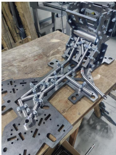
Rysunek 21. Połowa ramy umieszczona na stanowisku spawalniczym [opracowanie własne]
