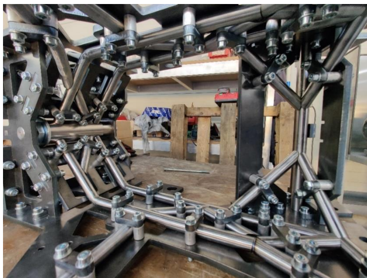
Rysunek 22. Złożone stanowisko z ramą gotową do spawania [opracowanie własne]
